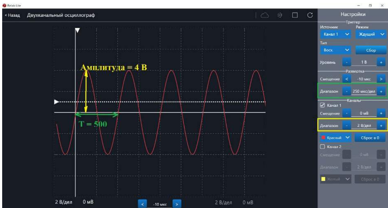
Рис. 42. Определение параметров осциллограммы
