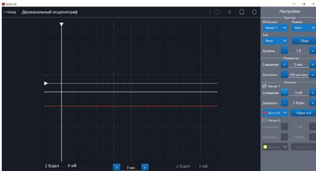
Рис. 40. Сигнал с ненулевым смещением
